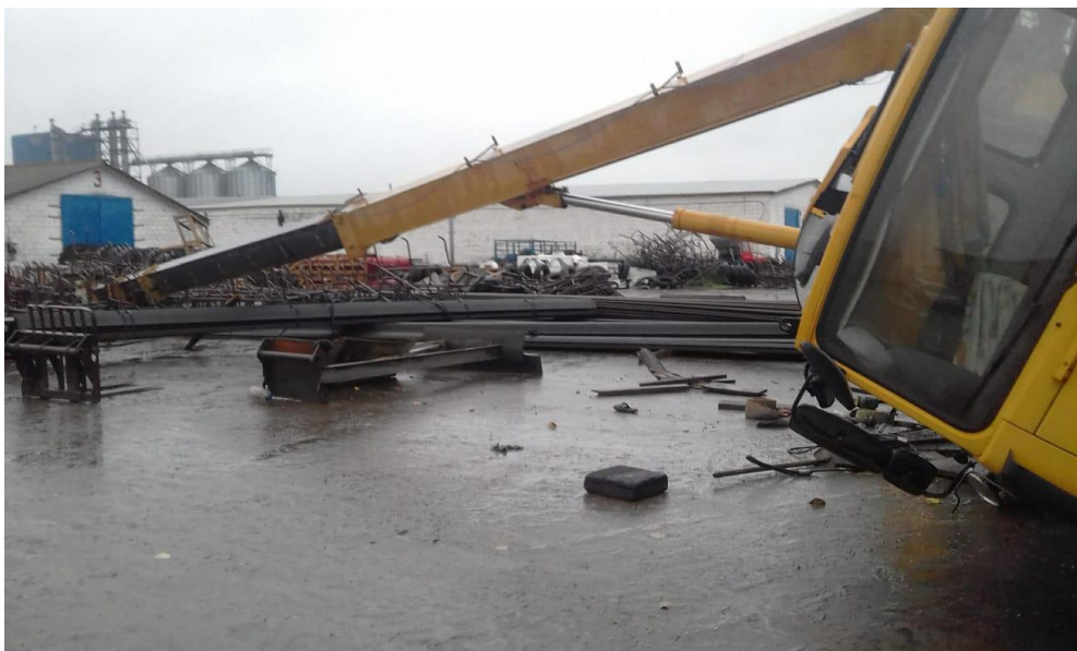
Фото 5. Определение длины стрелы крана во время опрокидывания
