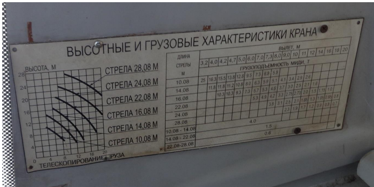
Фото 1. Высотные и грузовые характеристики крана (табличка в кабине)
