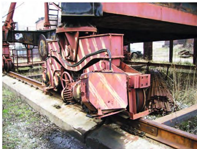
Рис.1. Балансирная тележка крана КБ-674А на рельсах Р50
