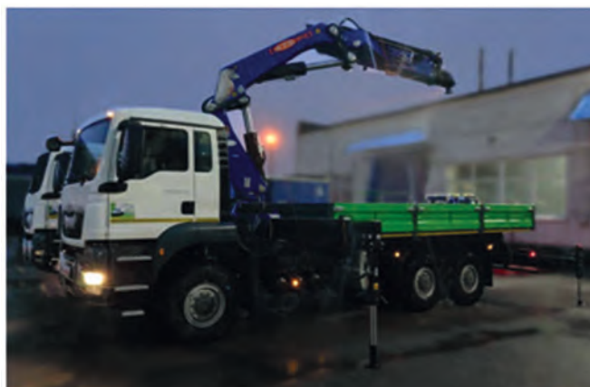
Бортовой автомобиль MAN TGS 33.440 с крано- манипуляторной установкой РМ 47522 РХ в рабочем положении
