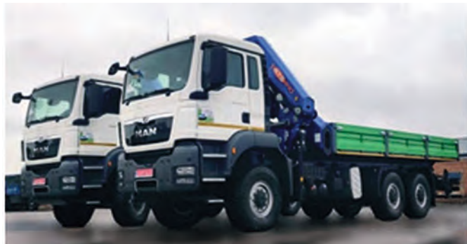
Бортовой автомобиль MAN TGS 33.440 с крано-манипуляторной установкой РМ 47522 РХ в транспортном положении
