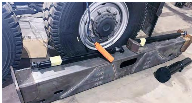
Аутригеры из высокопрочной стали
