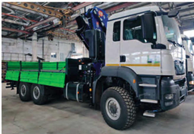
Монтаж крано-манипуляторной установки за кабиной бортового грузового автомобиля
